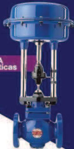
Las válvulas de control de dos vías Spirax Sarco modelo KE/KEA son fabricadas con el cuerpo en acero al carbono (KE/LEA 31/33). Tienen interiores con características equiporcentual (KE/KEA), lineal (KL/KLA) o de apertura rápida (KF/KFA) pueden ser utilizadas con actuadores neumáticos de acción inversa, de acción directa o con actuadores eléctricos.
