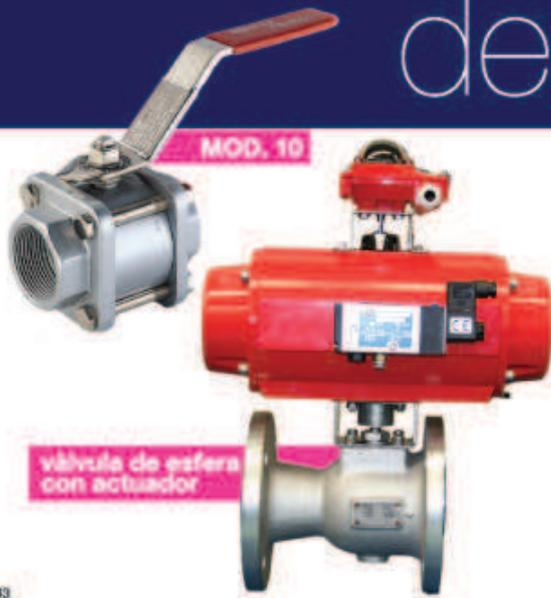
Con accionamiento mediante palanca manual o con actuador neumático o eléctrico. Ofreciendo seguridad absoluta en todas sus aplicaciones, las válvulas de esfera son ideales cuando se desea un cierre hermético en líquidos, vapor o gases. Son especialmente recomendadas para los casos en que su función no exclusivamente de bloqueo esto es, cuando no se considera necesario la modulación del caudal.
