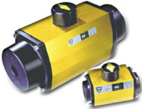
El actuador neumático doble “Rack and Pinion” de WORCESTER es uno de los mejores diseños del mercado. Disponible como “Doble Acción” (Aire-Aire) o “Regreso por Resortes” con torques de salida para válvulas pequeñas y grandes de un cuarto de vuelta.
