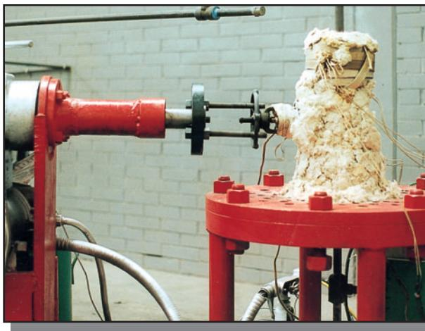
PRUEBAS DE LABORATORIO MEDICIÓN DE EMISIONES A ALTA TEMPERATURA, PRUEBAS DE CICLADO DE HASTA 500 CICLOS.
