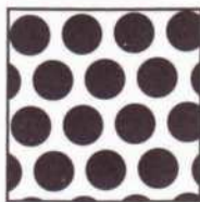
Diam 3/16" 18 perf./pulg 2 (50% área abierta)
