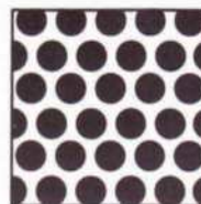
Diam 5/32" 33 perf./pulg 2 (62% área abierta)
