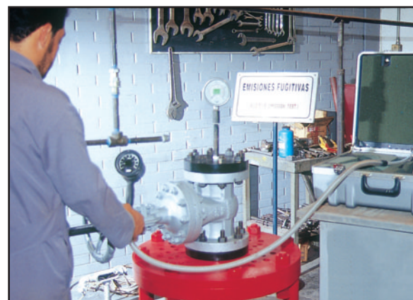
EQUIPOS DE MEDICIÓN E INSTALACIONES PARA GAS HELIO Y METANO.
