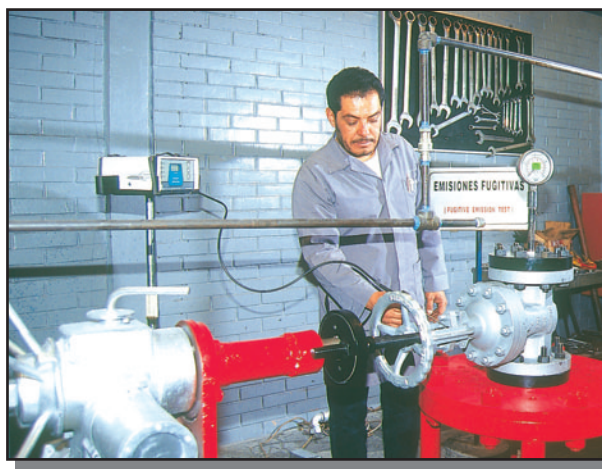
PRUEBAS DE LABORATORIO, MEDICIÓN DE EMISIONES CON GAS HELIO, PRUEBAS DE APERTURA Y CIERRE DE HASTA 1000 CICLOS.
