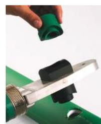
**3.** Coloque en el termofusor los dados especiales para monturas.
