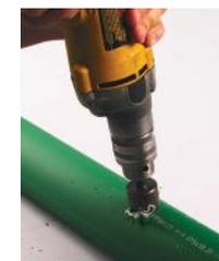
**2.** Coloque en el taladro el perforador para monturas y complete la perforación.
