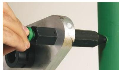
3. Introduzca el extremo macho del dado dentro del agujero del tubo, al mismo tiempo que introduce el tapón dentro del dado hembra hasta la marca. Determine el tiempo de calentamiento de acuerdo al diámetro del tubo (ver tabla 5 de tiempos de calentamiento).
