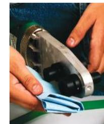
2. Limpie con un trapo húmedo en alcohol los dados del termofusor, para
