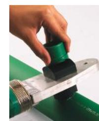
**4.** Primero caliente el tubo por espacio de 30 seg., hasta que se forme un anillo alrededor del dado. A continuación caliente la montura durante 20 seg., sin retirar el dado del tubo.
