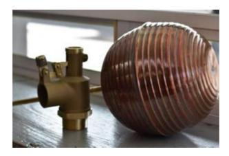
Una válvula de flotador, es aquella que regula el llenado de un tanque mediante un dispositivo que cierra y abre el paso del flujo de acuerdo al nivel de agua que tenga. El trabajo lo realiza una boya, la cual al flotar indica a la válvula si ésta debe permanecer abierta (permitiendo el paso de agua) o bien cerrarse, en el caso de que la boya se encuentre en el límite de llenado previamente establecido.
