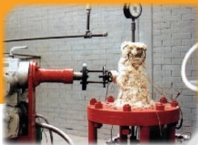
Pruebas de laboratorio, medición de emisiones a alta temperatura, pruebas de ciclado de hasta 500 ciclos.
