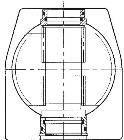
Sección del conjunto del cuerpo del actuador y del eje de salida
